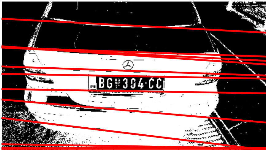
Slika 5: Prikaz pravih linija detektovanih Hafovom transformacijom
