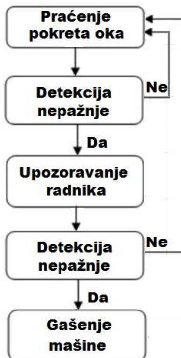
Slika 2: Prijedlog opšteg modela za povećanje bezbjednosti na industrijskom radnom mjestu korištenjem sistema za praćenje pokreta oka u realnom vremenu
