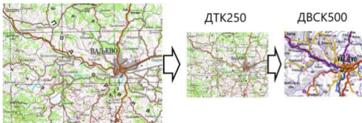
Slika 1: Deo sadržaja DTK250 (levo) fotografski umanjen za razmeru 1:500 000 (u sredini) i DVSK500 dobijenu kartografskom generalizacijom (desno)
