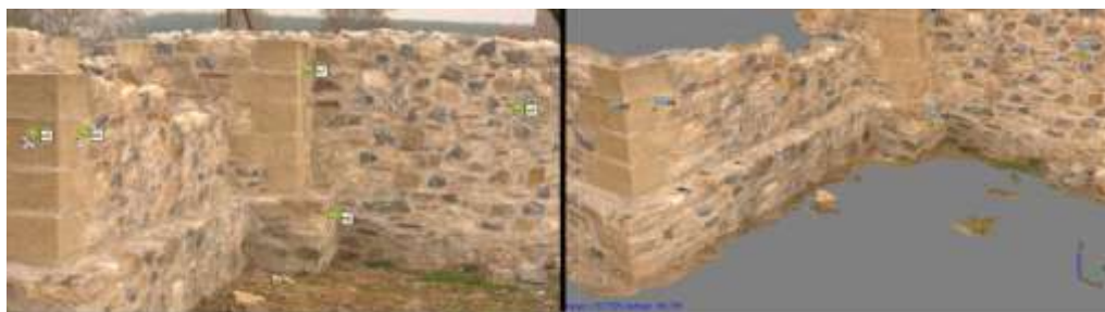
Slika 4: Izgled markera orijentacionih tačaka na snimku (levo) i na modelu (desno)
