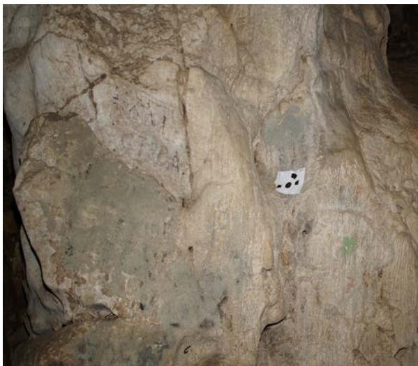
Слика 2: Фотосигналисана тачка кодним маркером и нефотосигналисана тачка на плафону
