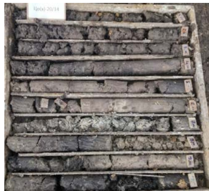
Slika 2: Uzorci (iz 2 bušotine) sa unutrašnjeg odlagališta površinskog kopa Polje C, kolubarski basen [6]
