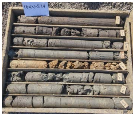
Slika 2: Uzorci (iz 2 bušotine) sa unutrašnjeg odlagališta površinskog kopa Polje C, kolubarski basen [6]
