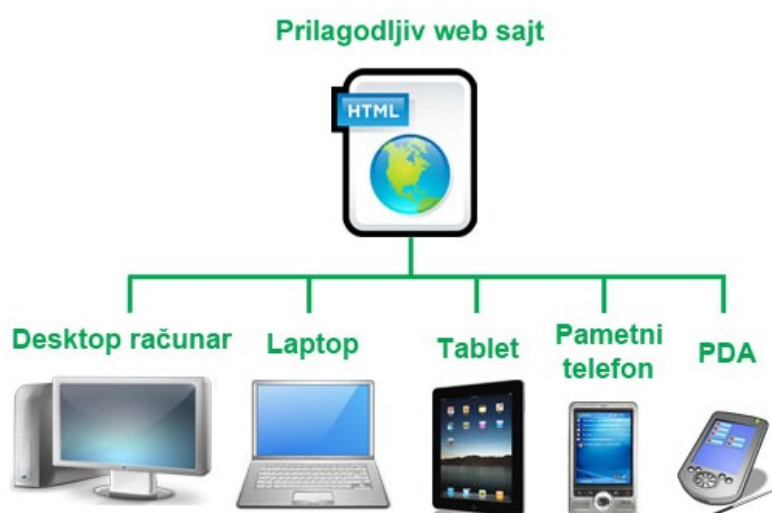
Slika 1: Prilagodljivi web dizajn obezbeđuje adekvatno prikazivanje istog sajta na različitim uređajima i pri različitim veličinama prozora web čitača
