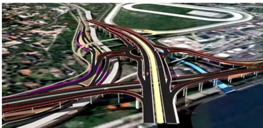
Slika 2. 3D simulacija projektnog rešenja denivelacije
