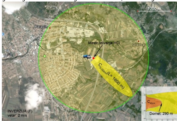
Slika 3: Zone prostiranja opasnih koncentracija HCl, za početne uslove disperzije (do 10 min od početka izlivanja) u uslovima stabilne atmosfere i pri brzini vetra od 2 m/s
