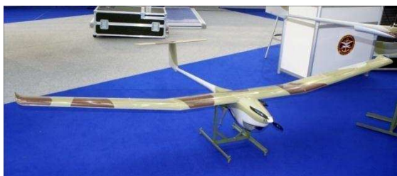
Слика 1. Домаћа електрична беспилотна летелица ВРАБАЦ, маса m=8.5 kg, Li-По батерије U=29.6 V, површина крила S=0.75 m 2
